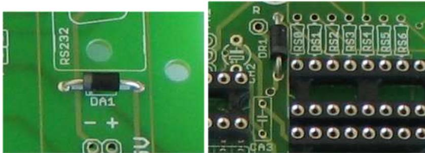
Fig. 4.14 e 4.15 - Montagem dos díodos DA1 e DR1
