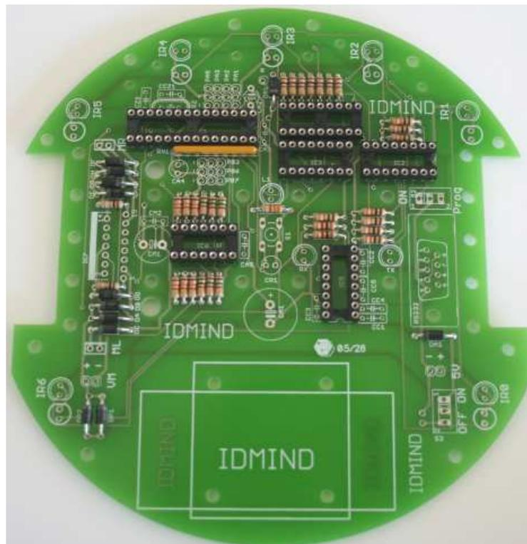
Fig. 4.24 - Montagem das Resistências na Placa.
