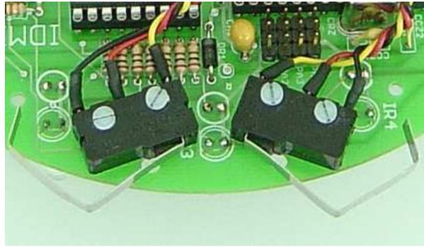
Fig. 4.44 - Montagem dos sensores de contacto.
