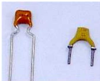
Fig. 4.5 - Condensadores cerâmicos (esquerda 100nF, direita 15pF)
