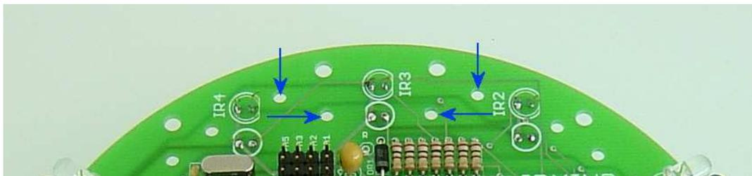
Fig. 4.43 - Local de fixação dos sensores de contacto.
