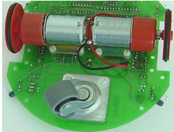
Fig. 4.40- Montagem dos motor e roda livre
