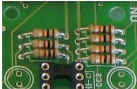
Fig. 4.21 - Montagem das Resistências de 1KΩ.
