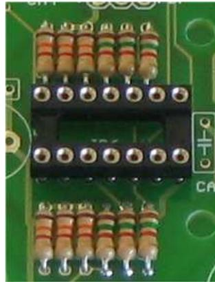
Fig. 4.20 - Montagem das Resistências de 1.3KΩ.
