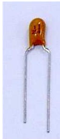
Fig. 4.8 - Condensadores Tantalum 1 $\mu$ F
