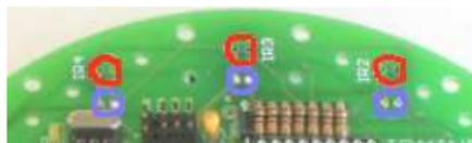
4.33 - Locais de montagem dos sensores de infravermelhos
