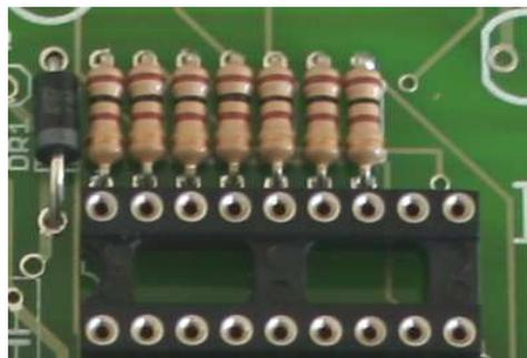
Fig. 4.22 - Montagem das Resistências de 100Ω.
