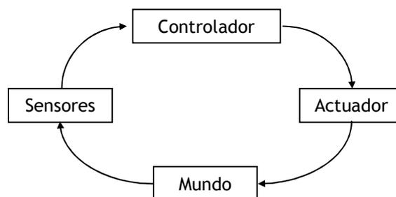
Fig. 1.2 - Ciclo de funcionamento de um Robô
