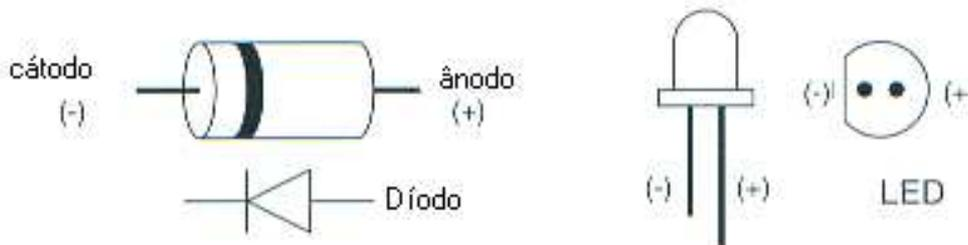
Fig. 4.9 - Polaridade dos díodos e *leds*
