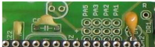
Fig. 4.26 - Montagem dos condensadores de 15pF e tantalum.
