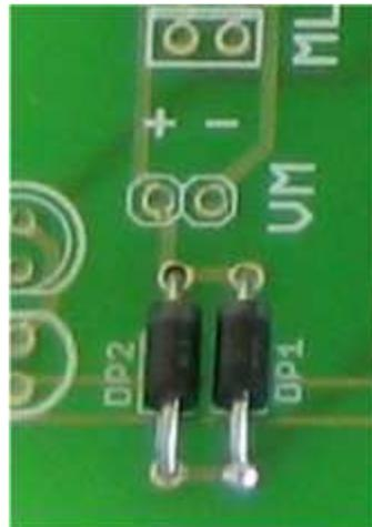
Fig. 4.13 - Montagem dos díodos DP1 e DP2
