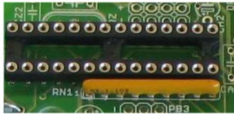
Fig. 4.23 - Montagem do Pack de Resistências de  $10K\Omega$ .
