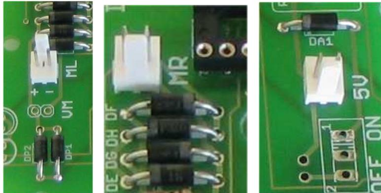
Fig. 4.28, 4.29, 4.30 - Montagem dos terminais em ML, MR e 5V
