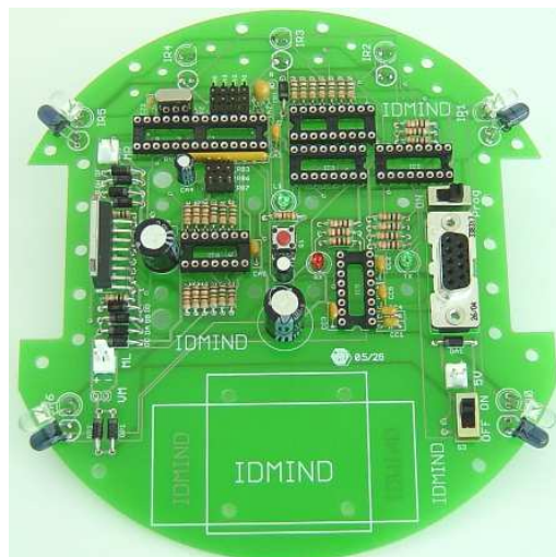
4.35- Montagem dos sensores de chão
