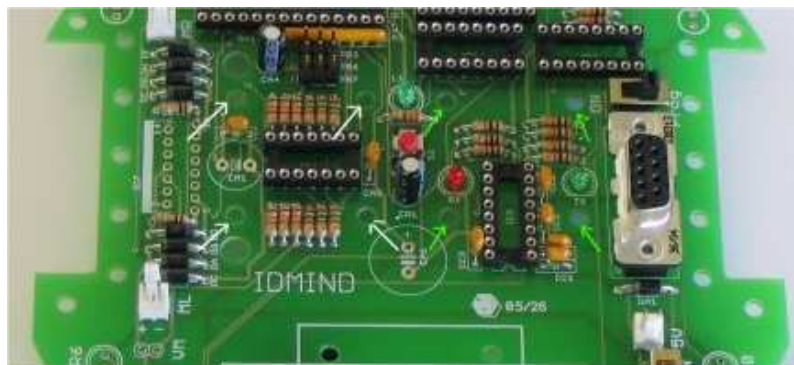
4.38- Locais de montagem dos motores
