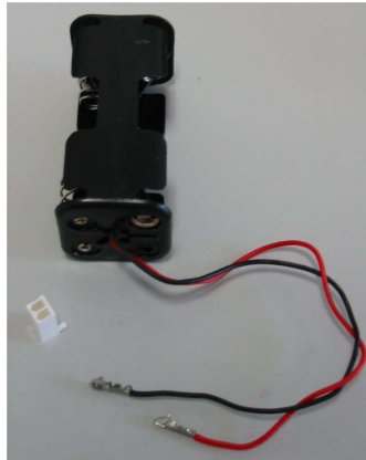
4.36- Montagem do suporte de Pilhas
