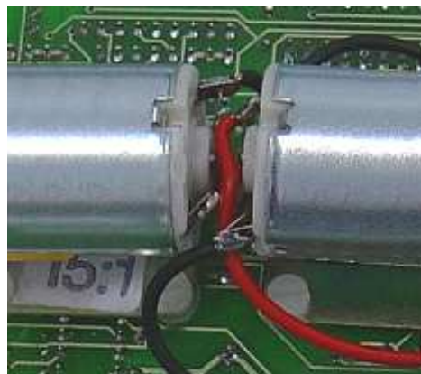
4.39- Disposição dos terminais do motor para um funcionamento correcto.
